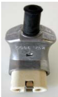
Artikel nr.1190-1002.00 SES stickpropp 25A 380V i silumin vinkel hona med gummihätta.
