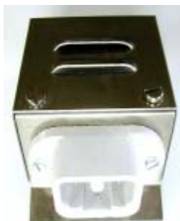
Artikel nr.1190-1013.00 SES kontaktarmatur 16A 250V radial, med hus. Passar till stickpropp Artikel nr.1190-1007.00
