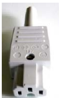
Artikel nr.1190-1007.00 SES stickpropp rak 10A 250V max temperatur 200°C.
